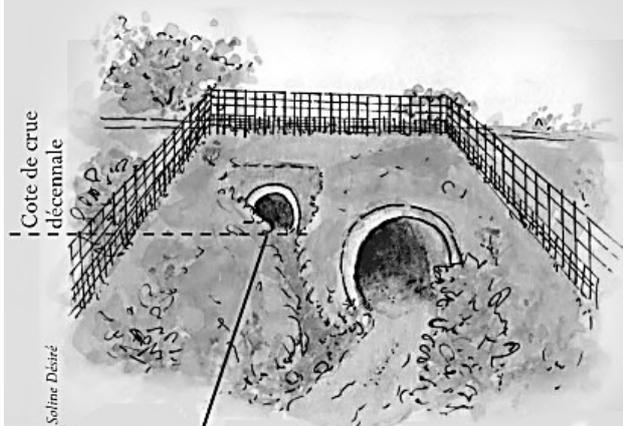
Buse sèche placée au plus près de l'ouvrage, dans le prolongement de la berge, au dessus du niveau de crue.
