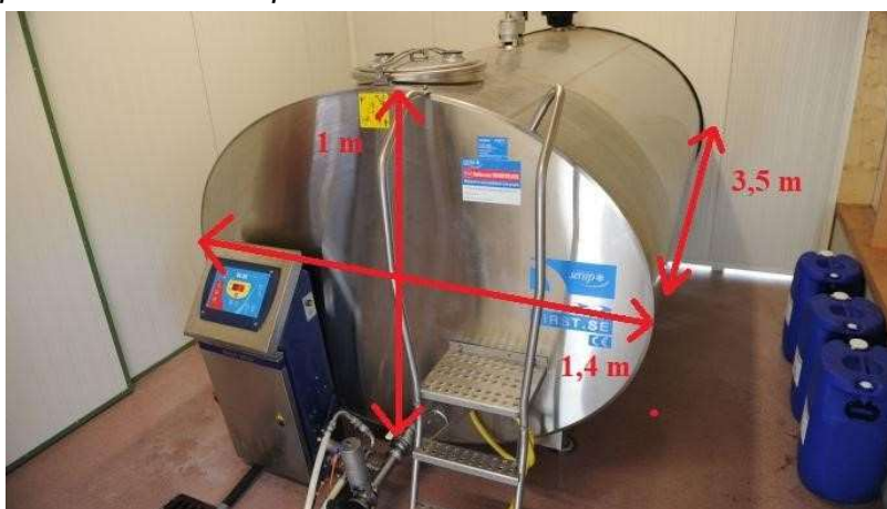
Tank à lait de Mr Lactel et ses dimensions
